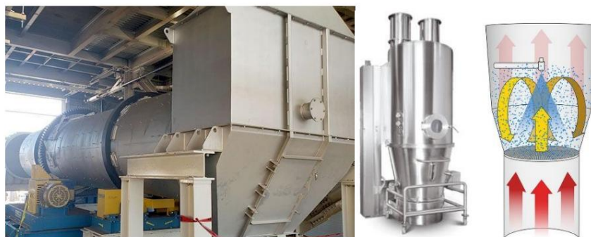
Priemyselný granulačný bubon (b), priemyselné zariadenie s fluidným lôžkom [7] (k), princíp činnosti [6]
